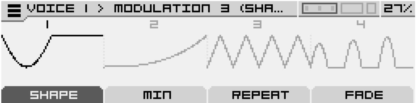
Il s'agit d'un mode d'affichage alternatif pour le séquenceur de formes où tous les paramètres de l'onglet Étapes du Mode Édition sont réorganisés afin que vous puissiez modifier rapidement le même paramètre sur plusieurs étapes. Notez que ces paramètres ne peuvent pas être modulés.
